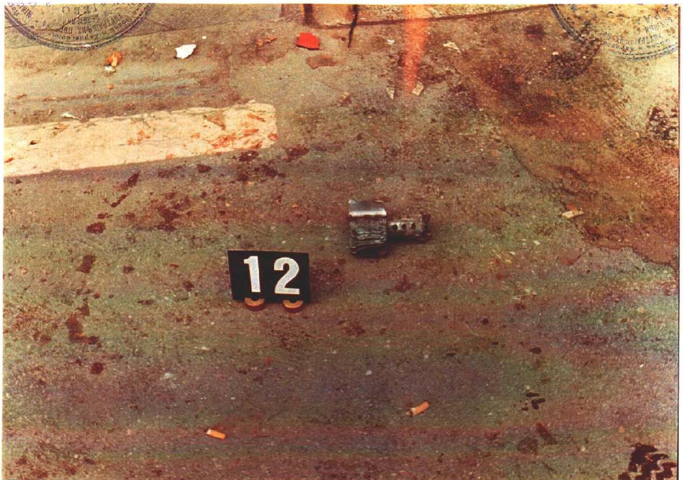
Bliži izgled stabilizatora projektila.
