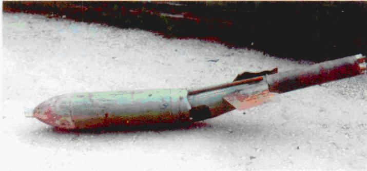
Sl. 93. Avionska bomba FAB-100 sa raketnim motorom 128 mm M74 MUNJA
