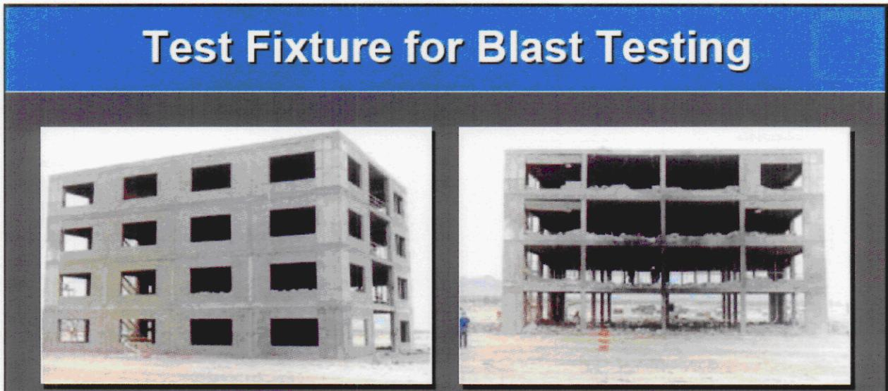
Sl. 50. Efekti djelovanja udarnog talasa izazvanog eksplozivom van zgrade<sup>13</sup>
