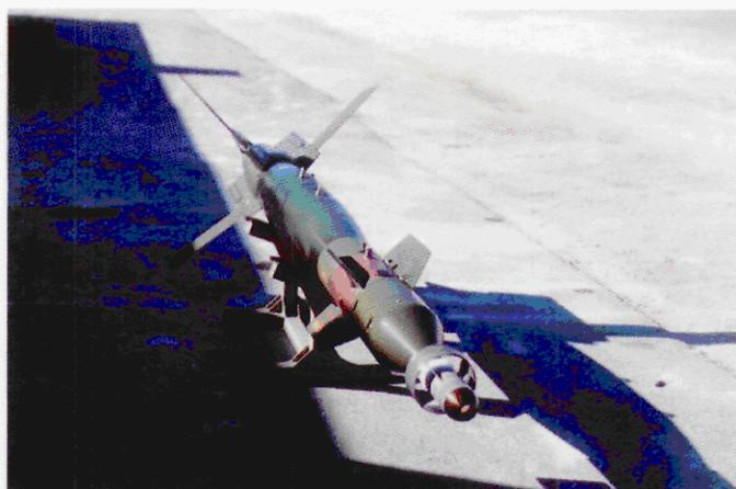
Avionske bombe sa elektro-optičkim, TV ili infra-crvenim vođenjem sadrže kontrolni modul, krila-1 (fins), elektro-optički tragač-3 (seeker) pomoću kojeg pilot izabira cilj. Kada pilot izabere cilj, prije lansiranja bombe, sistem za vođenje preuzima dalje praćenje cilja i automatski vodi do cilja-4. TV vođenje je uspješno po lijepom vremenu, dok pri lošoj vidljivosti i noću potrebno je koristiti infra-crveni tragač.
